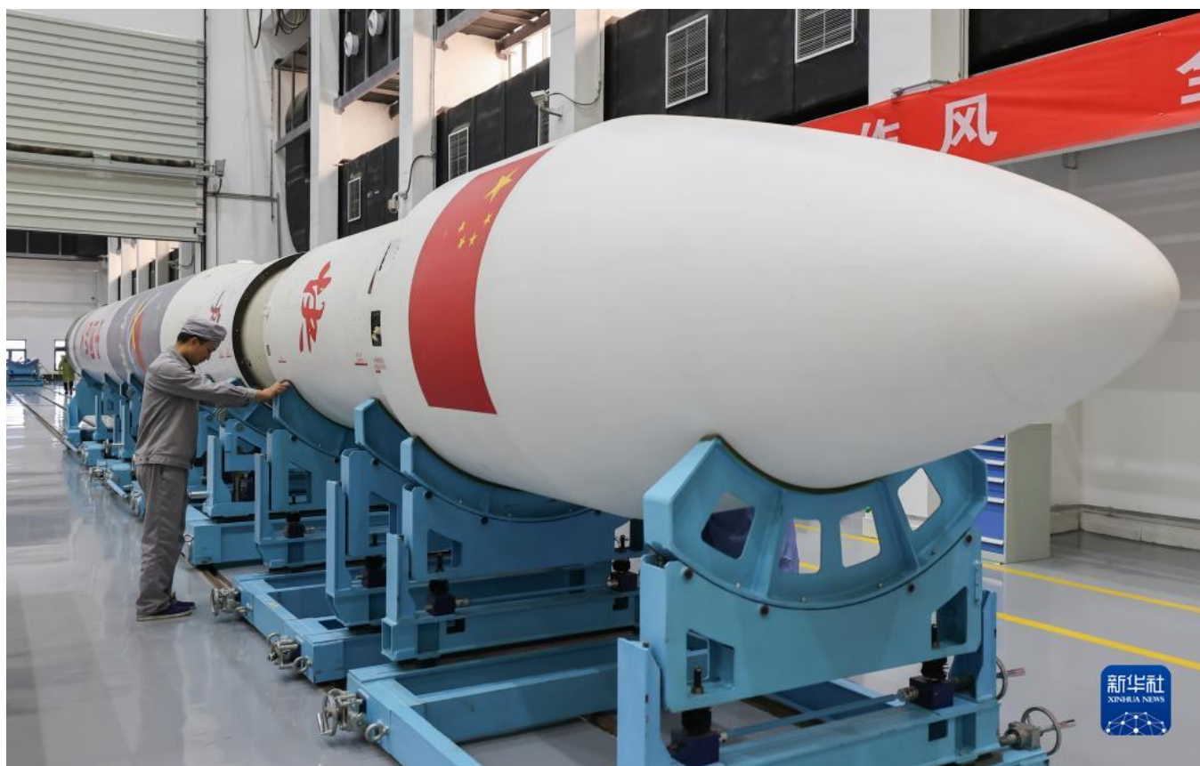
在武汉国家航天产业基地火箭产业园总装测试厂内，技术人员在对一发火箭进行舱段对接状态检查(2022年7月15日摄)。新华社记者 程敏 摄
