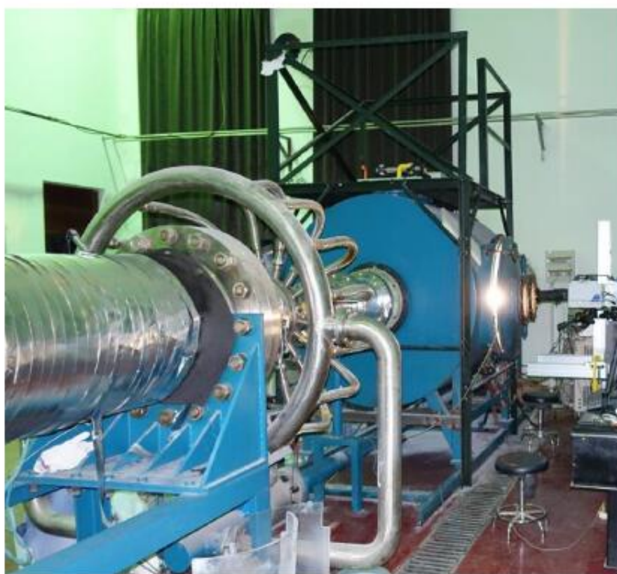
北京大学 \Phi 300\text{ mm} 高超声速静风洞
