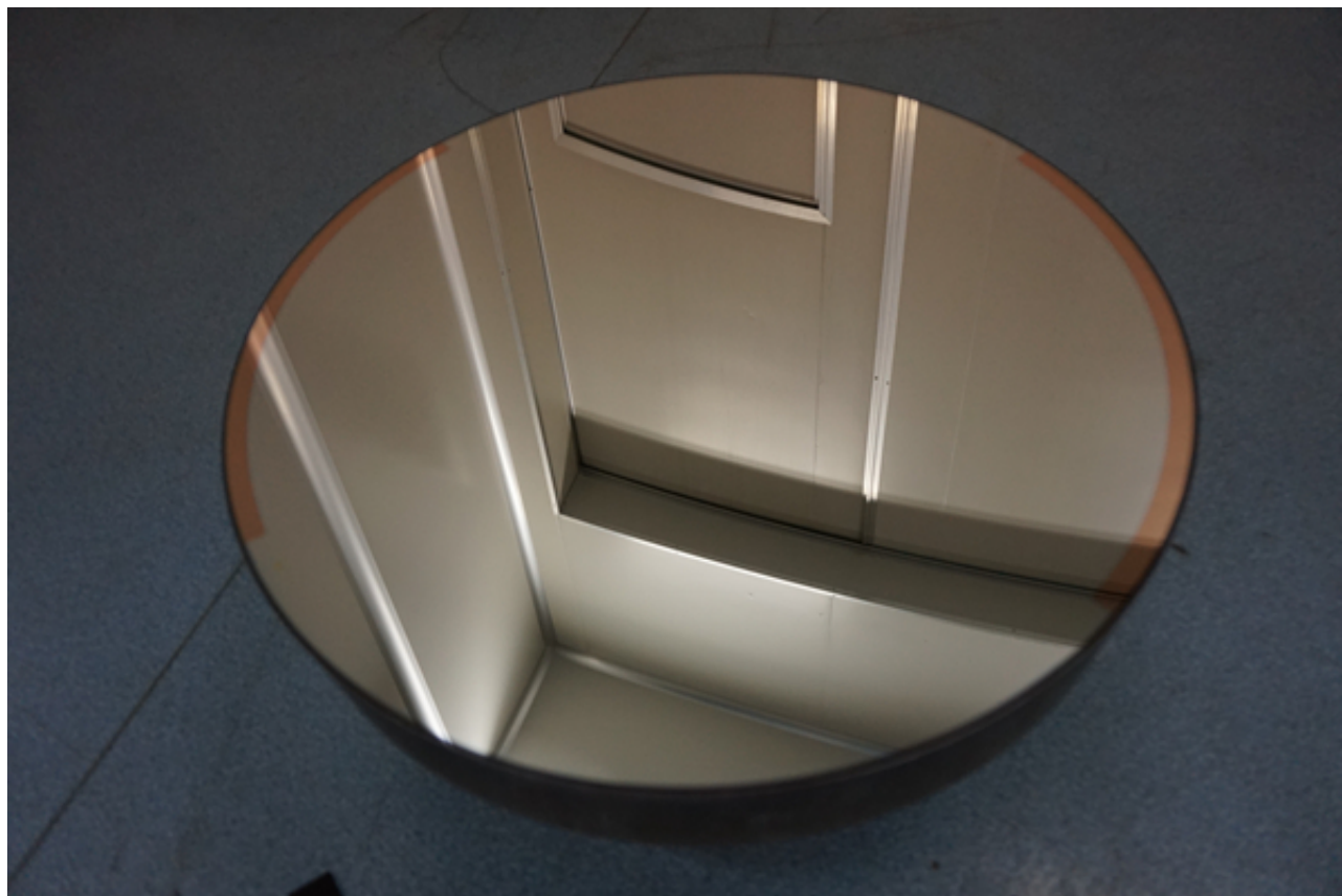
具有防霜反射膜系的 \Phi 520\text{mm} 球面反射镜
