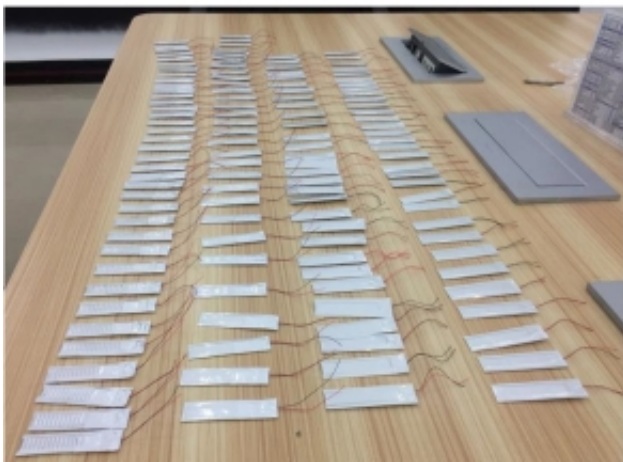
材料合成与器件设计示意图、制备的铝塑锂离子电容器及其原位柔性测试
