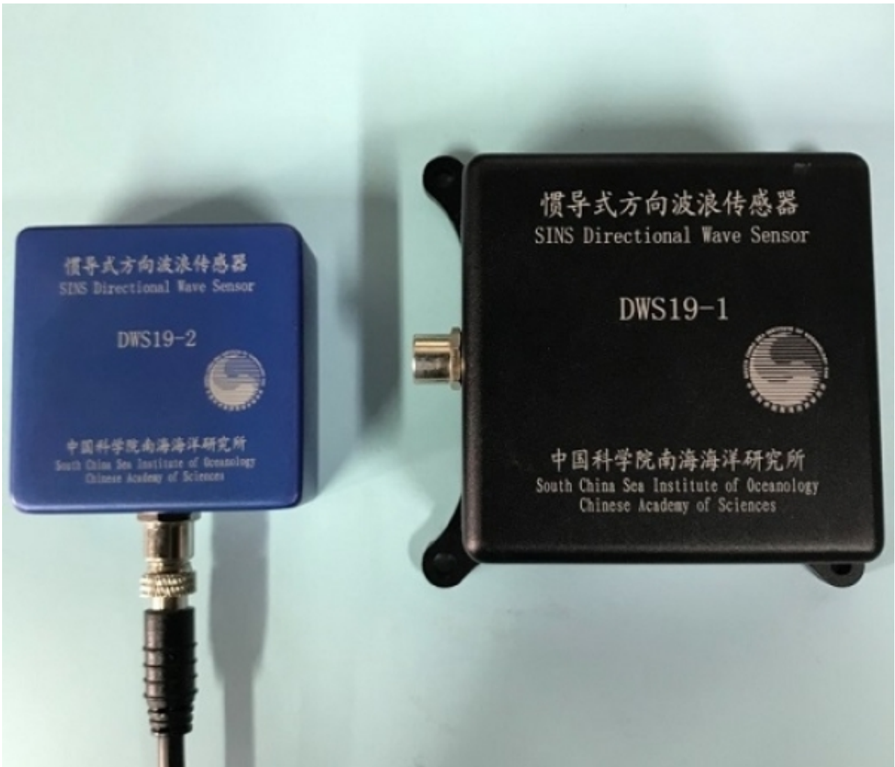
图2.DWS19-1/2型惯性波浪传感器
