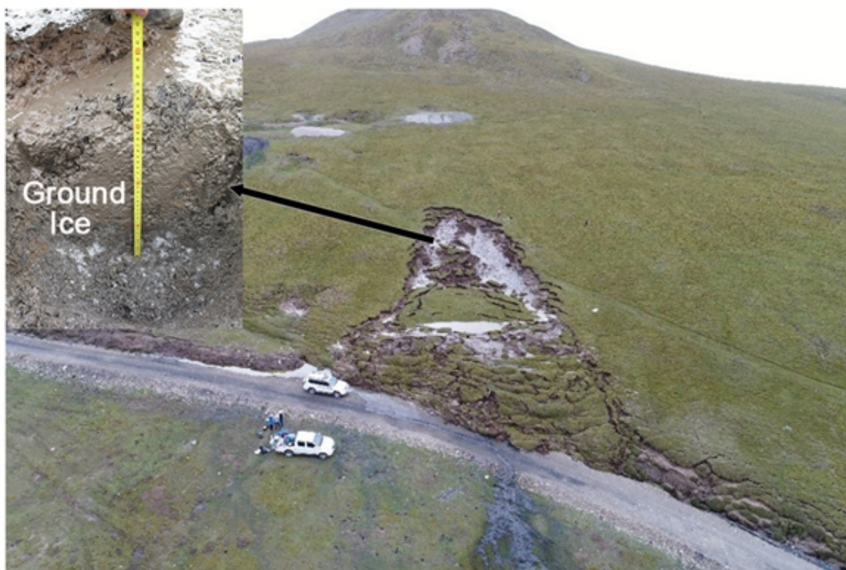
图2 青藏高原多年冻土退化引起的滑坡（暴露区可见地下冰）
