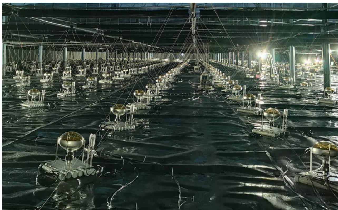
2020年7月，完成安装的WCD-3号探测器PMT阵列
