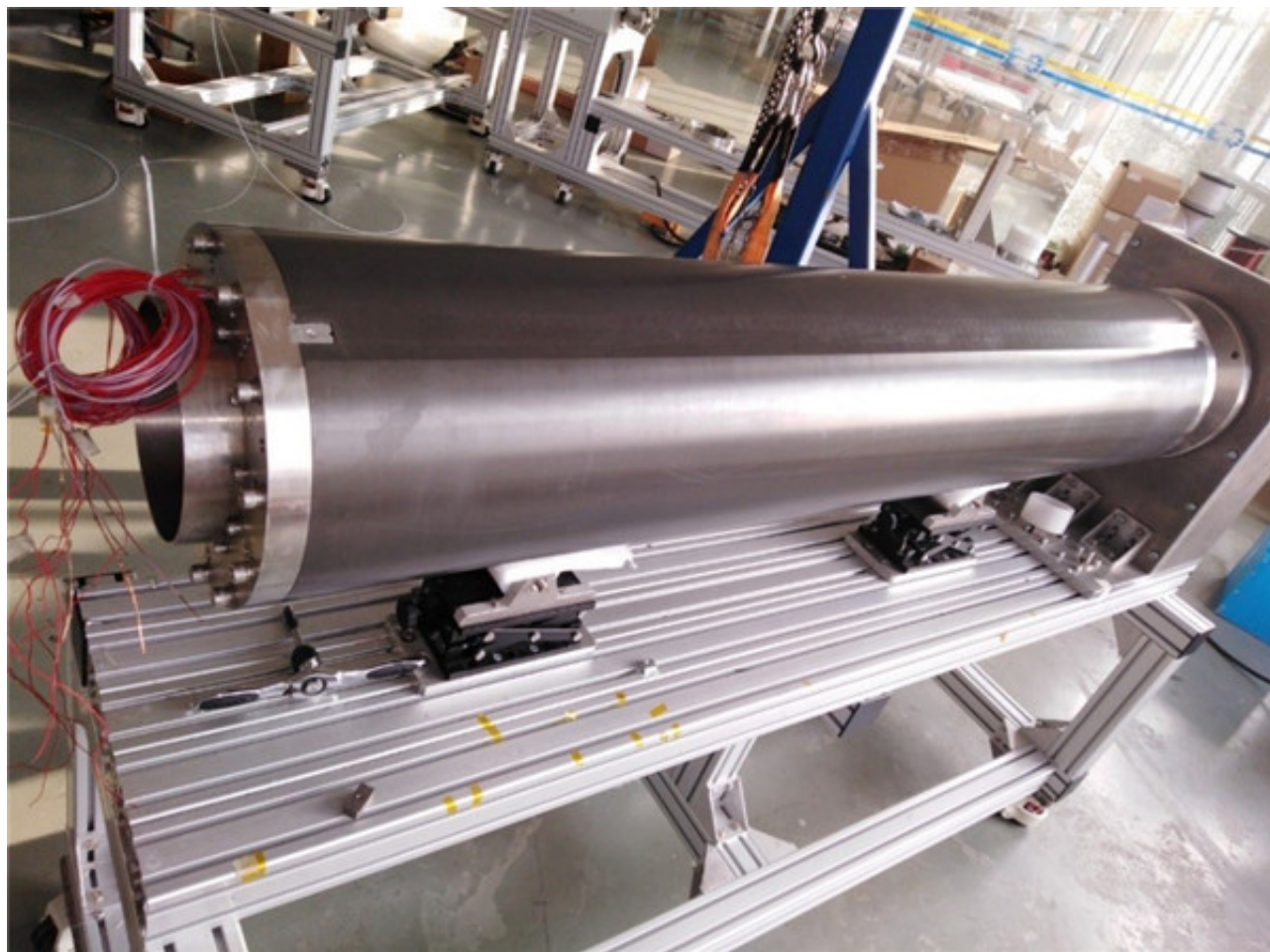
图1.半孔径CCT四六极超导组合磁体样机
