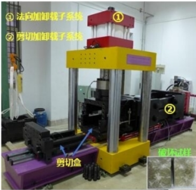
图2.新型多功能岩体剪断/裂面剪切高压伺服剪切试验系统
