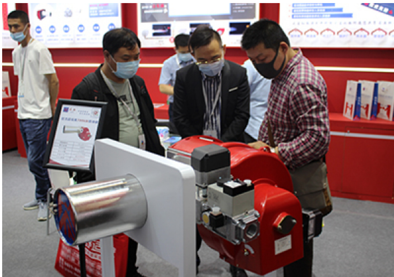
应用层流燃烧技术的燃气直燃超低氮燃烧器
