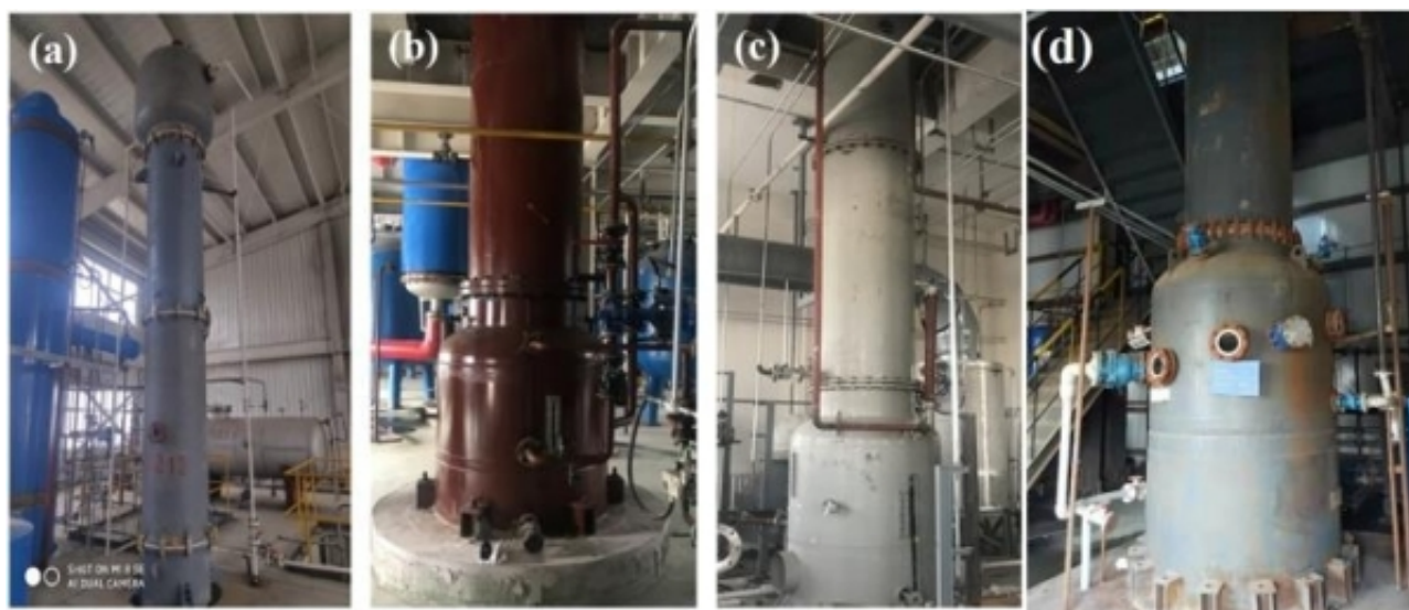
图3. (a) 含噻唑废水萃取塔；(b) 含苯酚废水萃取塔；(c) 烯草酮生产中酸洗、水洗塔；(d) 含特戊酸废水萃取塔
