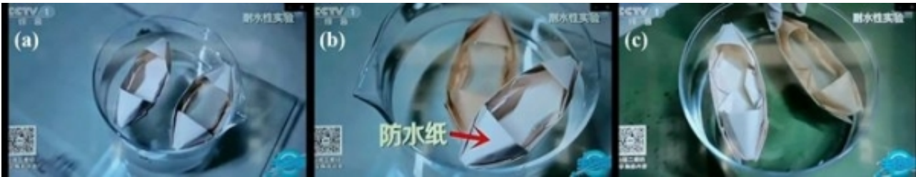
图3 耐水性实验 (a) 初始状态；(b) 浸泡0.5 h；(c) 浸泡8 h
