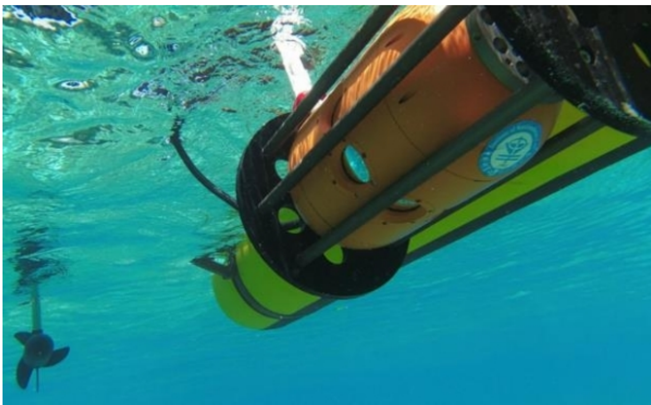
图2.搭载“冲浪者号”走航式观测过程中的“水睛”摄像机
