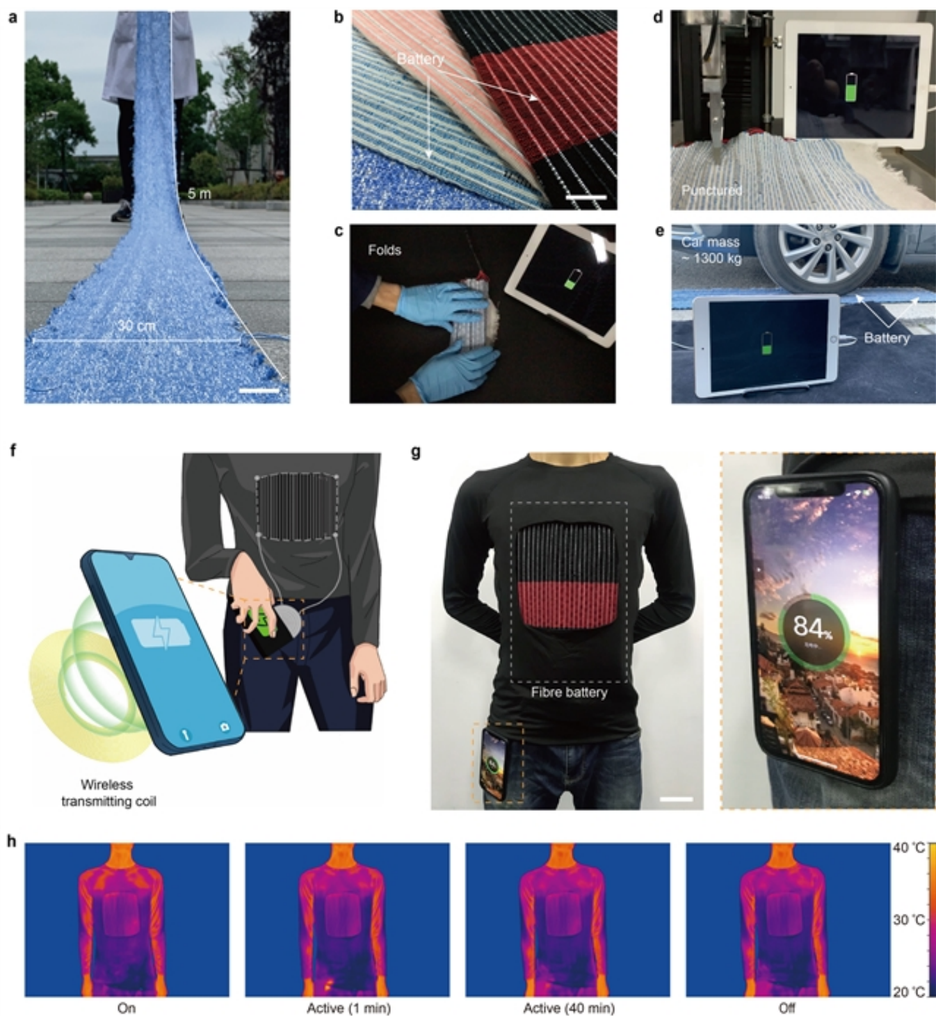
图3：a-e) 通过纺织方法获得高性能和高安全性的纤维锂离子电池织物；f-h) 纤维锂离子电池织物为智能手机进行无线充电。
