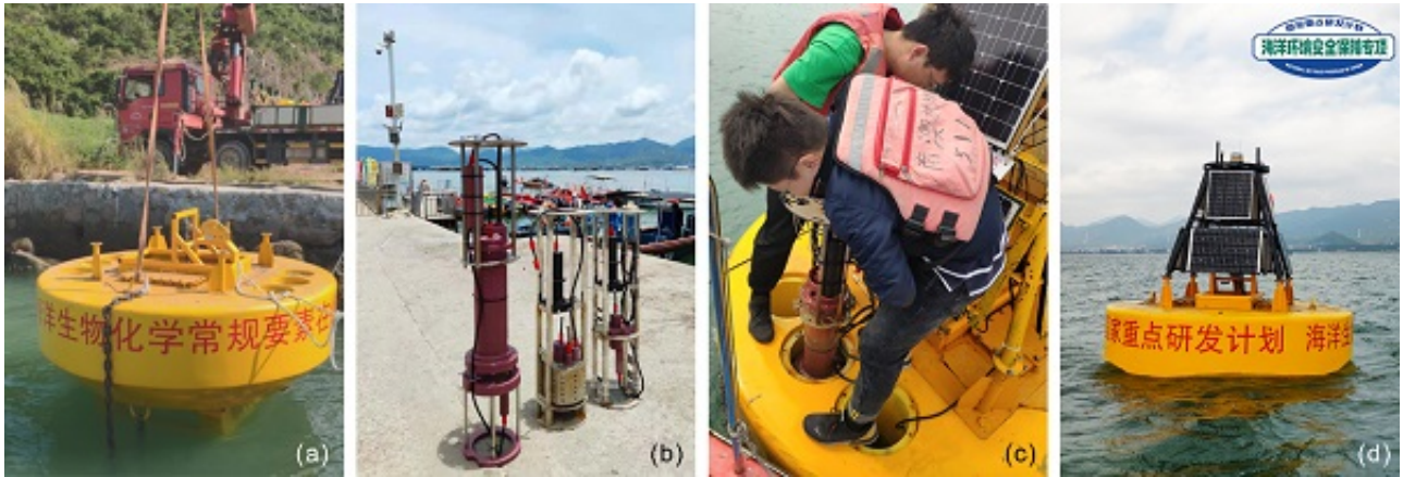
图1 近海锚系浮标基水下浮游生物原位成像仪
