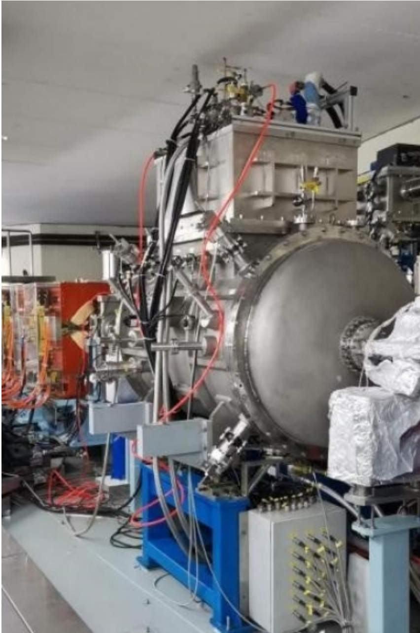
安装在储存环上的超导波荡器样机
