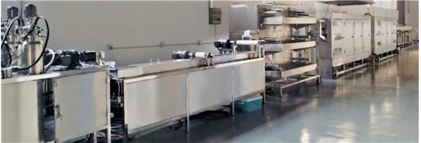
图2：聚合物湿法纺丝制备纤维电池的产线
