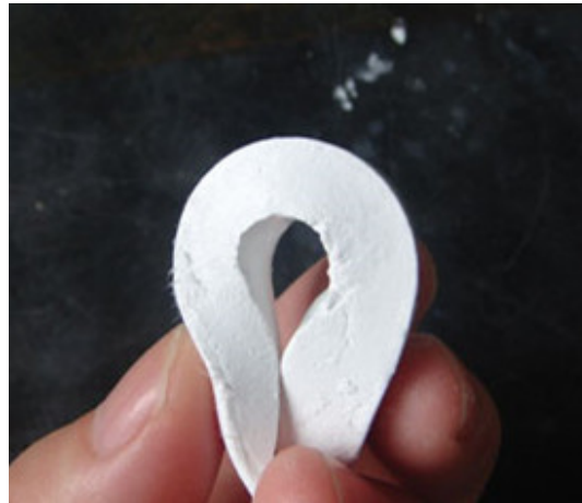
由PIBM体系制备的Al 2 O 3 陶瓷湿坯
