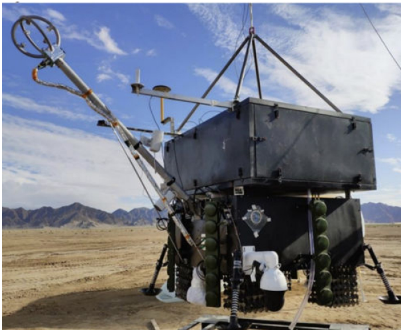
浮空平台风速计与临近空间综合环境探测实验舱
