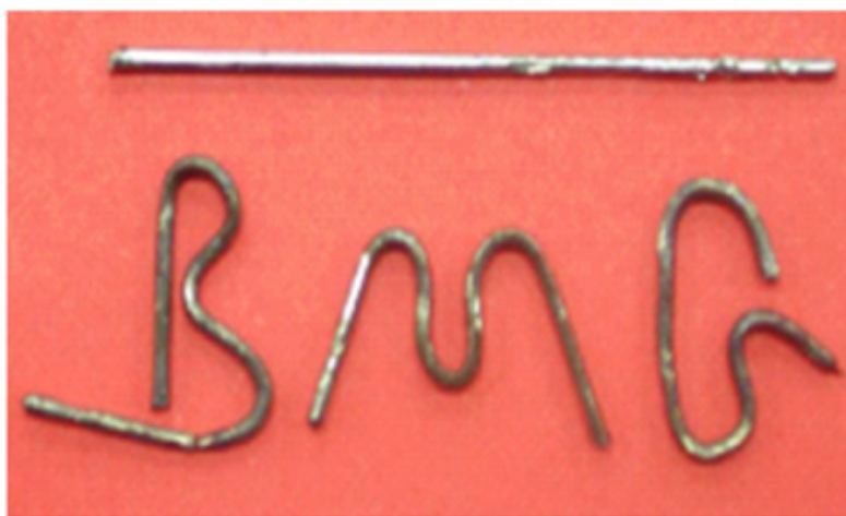
图1.具有低 T_g 点 ( \sim 67^\circ\text{C} ) 的Ce-基非晶合金，在开水中即可进行弯曲变形，被称为“金属塑料”。
