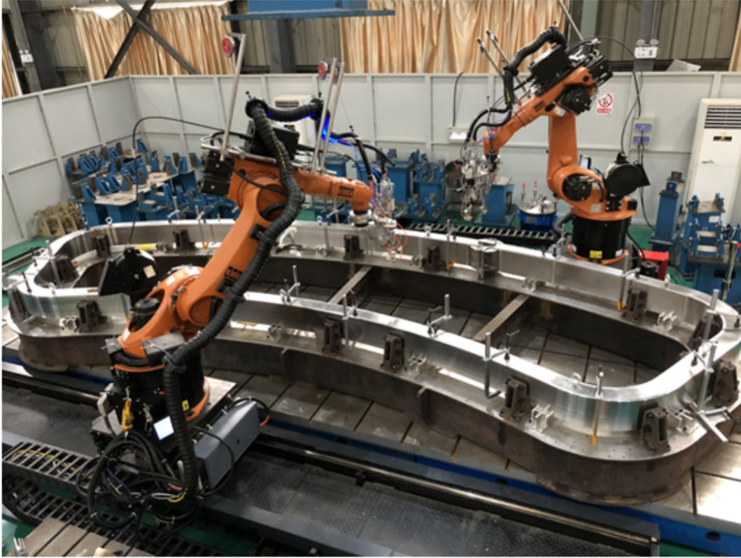
ITER BCC线圈盒激光焊接
