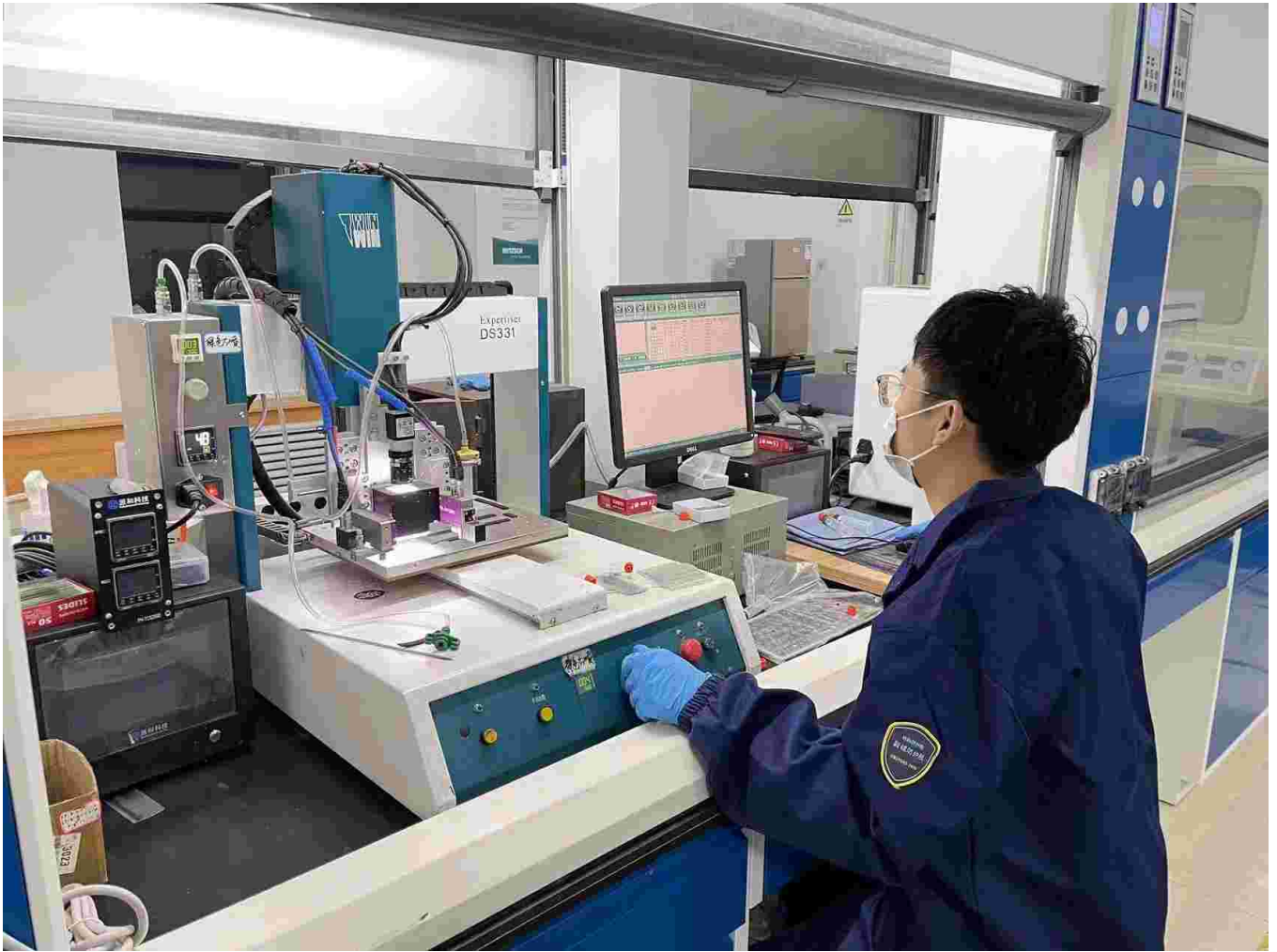
李晨阳利用3D打印设备进行含能油墨定制化成型。受访者供图
