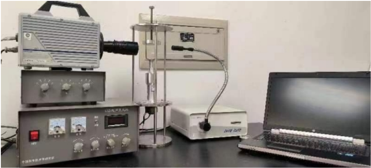
图1.驻波场声悬浮实验平台（声学所）
