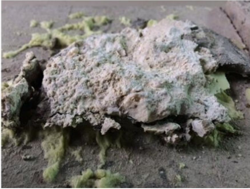
图3.砂屑灰岩-混凝土黏结面剪切破坏特征
