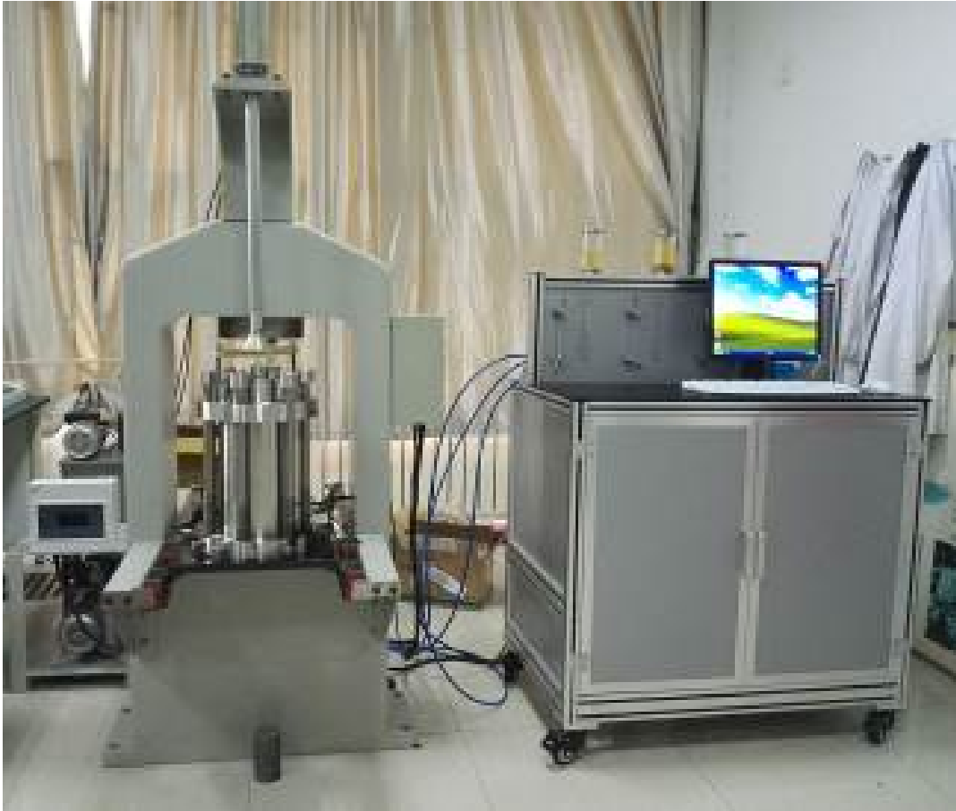
图3岩石温度-渗流-应力-化学(THMC)多场耦合试验系统
