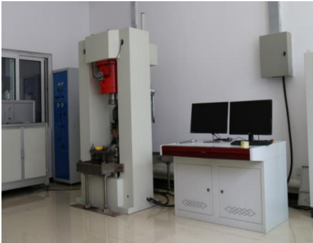
图2岩石动静力三轴高压(流变)试验系统
