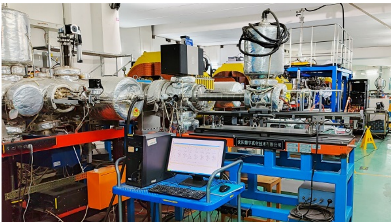
基于兰州重离子加速器的原子核质量测量探测装置
