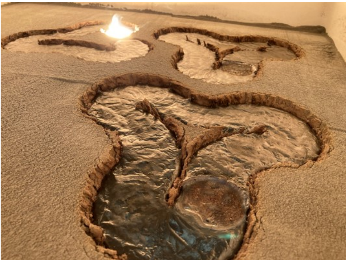
在45毫米激光光斑上输出3千瓦激光功率，在EAC-1A粉末床上打出可以互相套嵌的结构。图片来自：Jens Gunster
