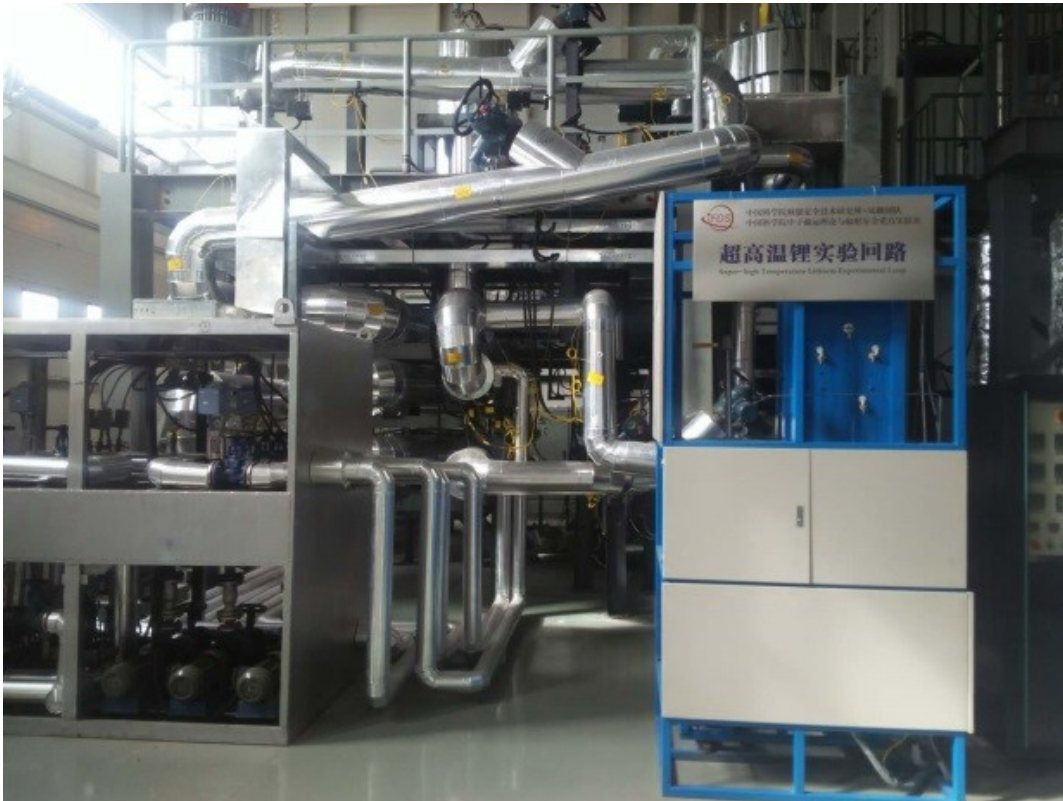
图1超高温液态金属锂实验回路
