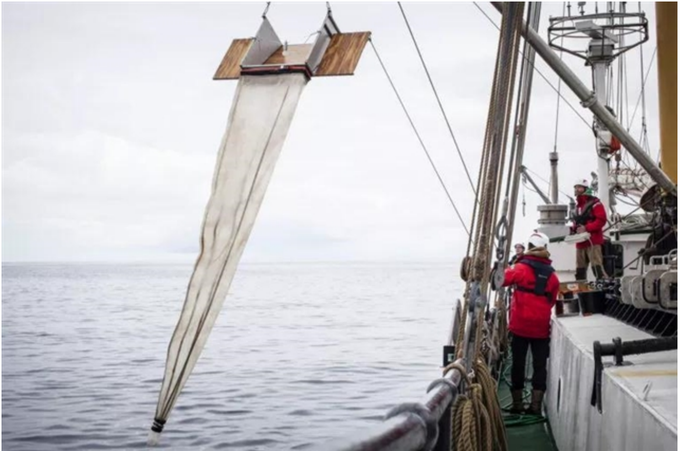
图2. 2017年5月，在苏格兰海域使用牵引的蝠网对塑料微粒进行取样。
