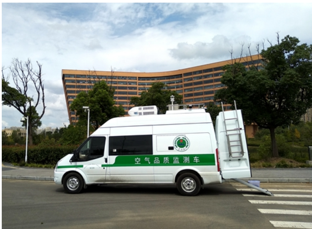
车载开放光路面源排放VOCs监测系统
