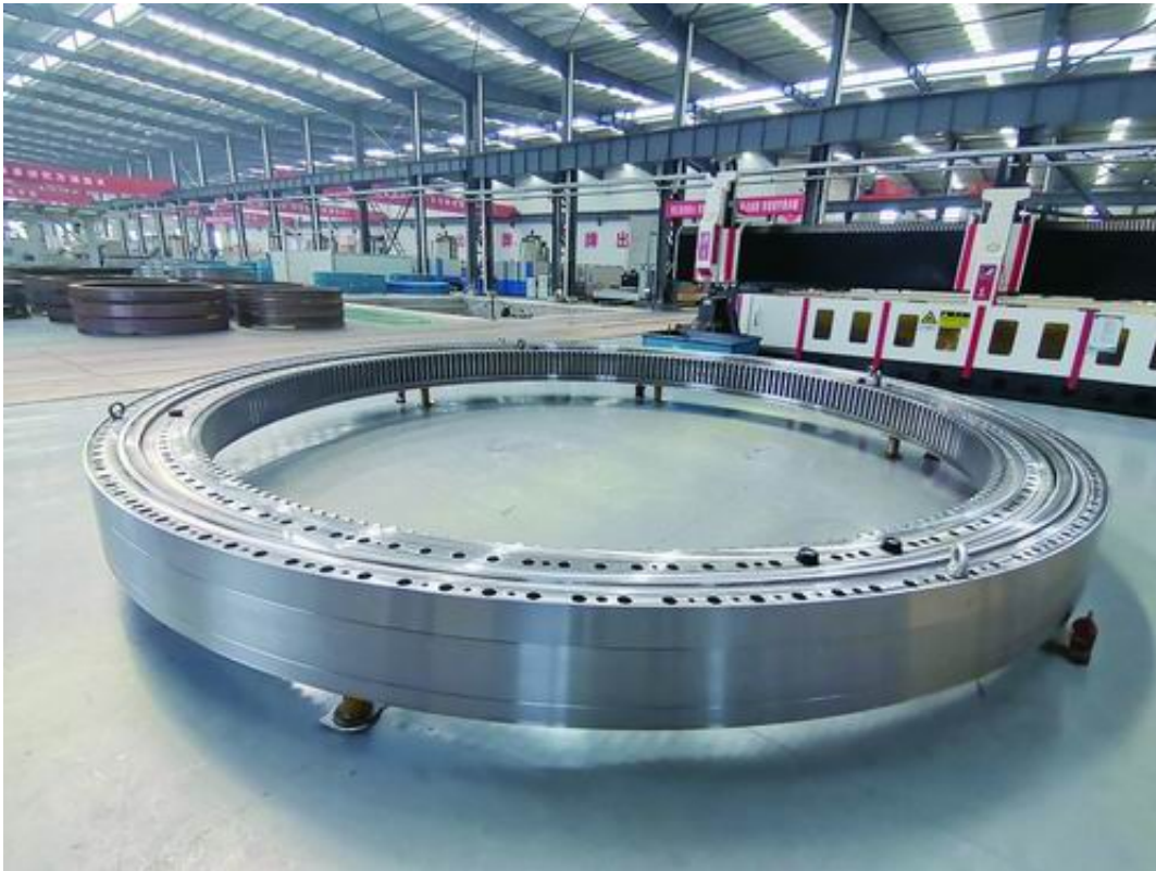
自研超大型盾构机用直径8米级主轴承。
