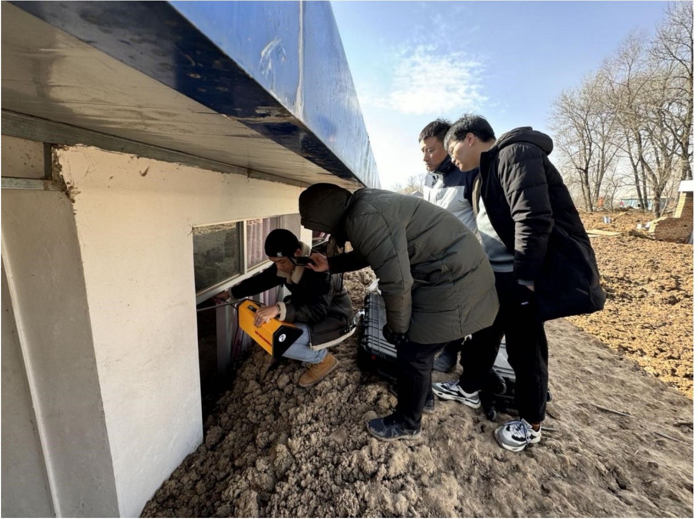
团队对受灾房屋内进行痕量气体探测。
