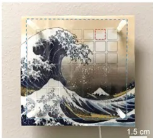
图3：贴片天线与法布里-珀罗腔体天线的实物照片及辐射方向图
