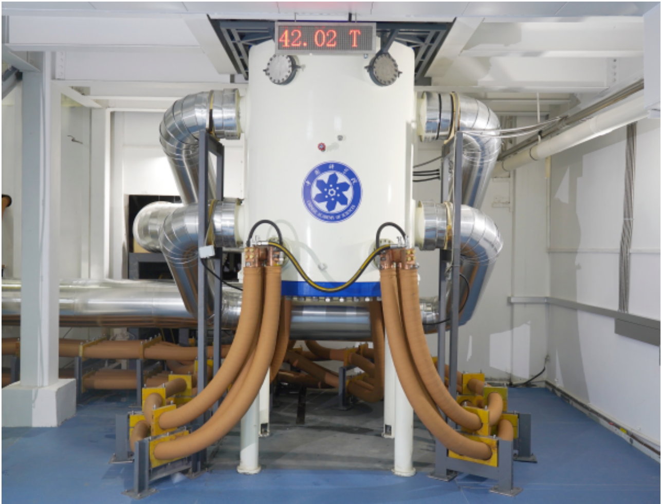
稳态强磁场42.02万高斯水冷磁体
