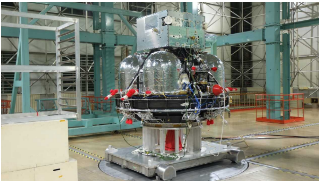
“微笑卫星”正样磁测试试验（照片来源：中国科学院微小卫星创新研究院）
