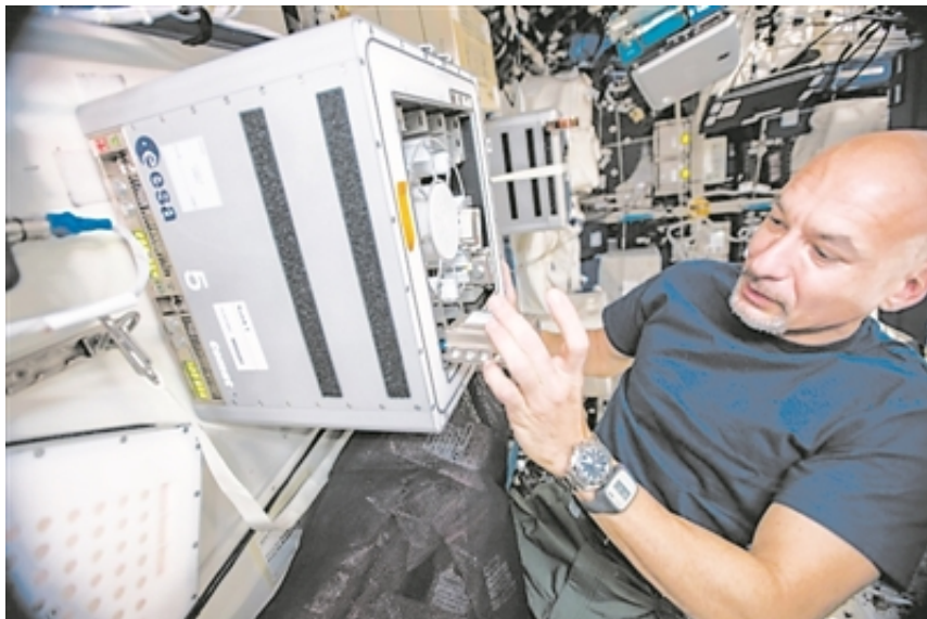
欧洲宇航员正在国际空间站上安装“生物岩石”项目的实验装置。图片来源：欧洲空间局
