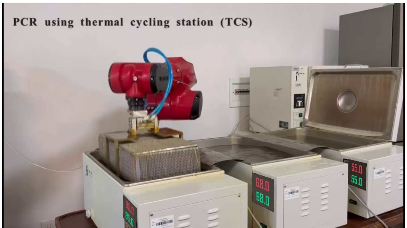
该团队研发的国产智能PCR工厂半自动热循环工作站。中国水稻所供图
