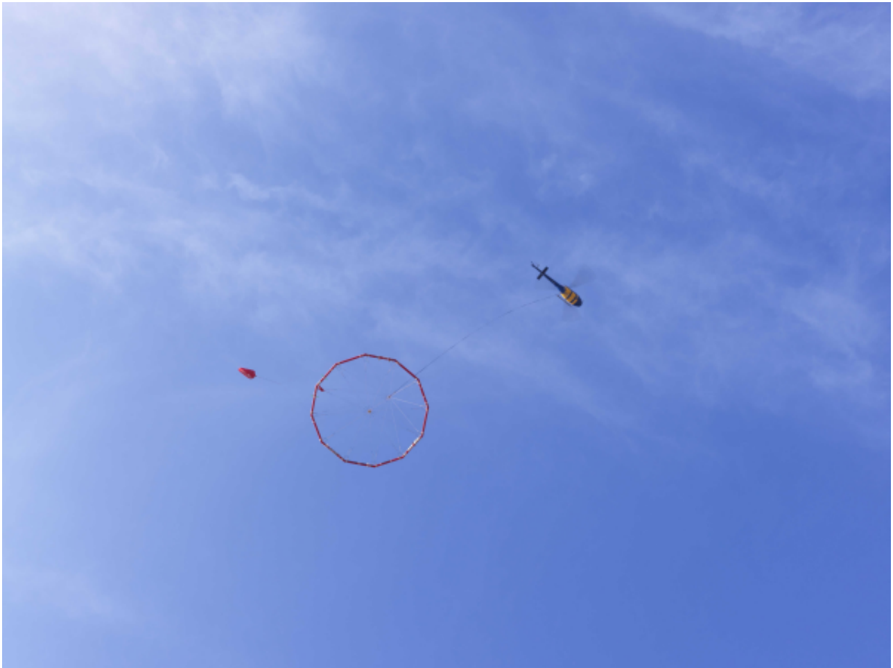
航空大地电磁探测系统在新疆和田地区进行飞行探测作业
