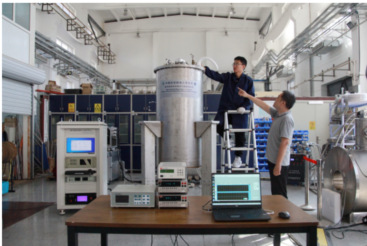
大口径高场超导磁体测试现场
