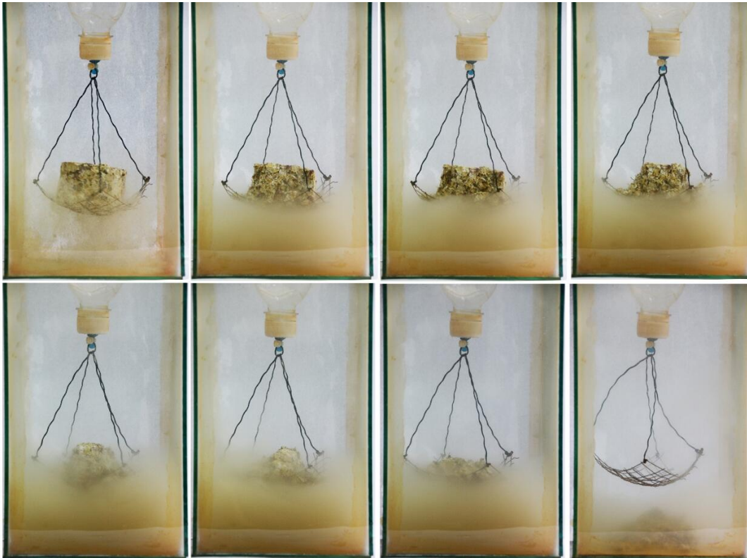
图3花岗岩风化土的崩解过程
