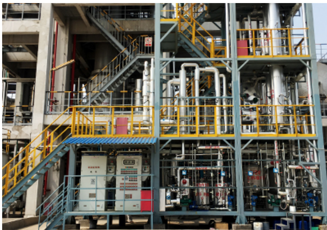
大连化物所建成正丁醛一步催化转化制备丁酸丁酯中试装置
