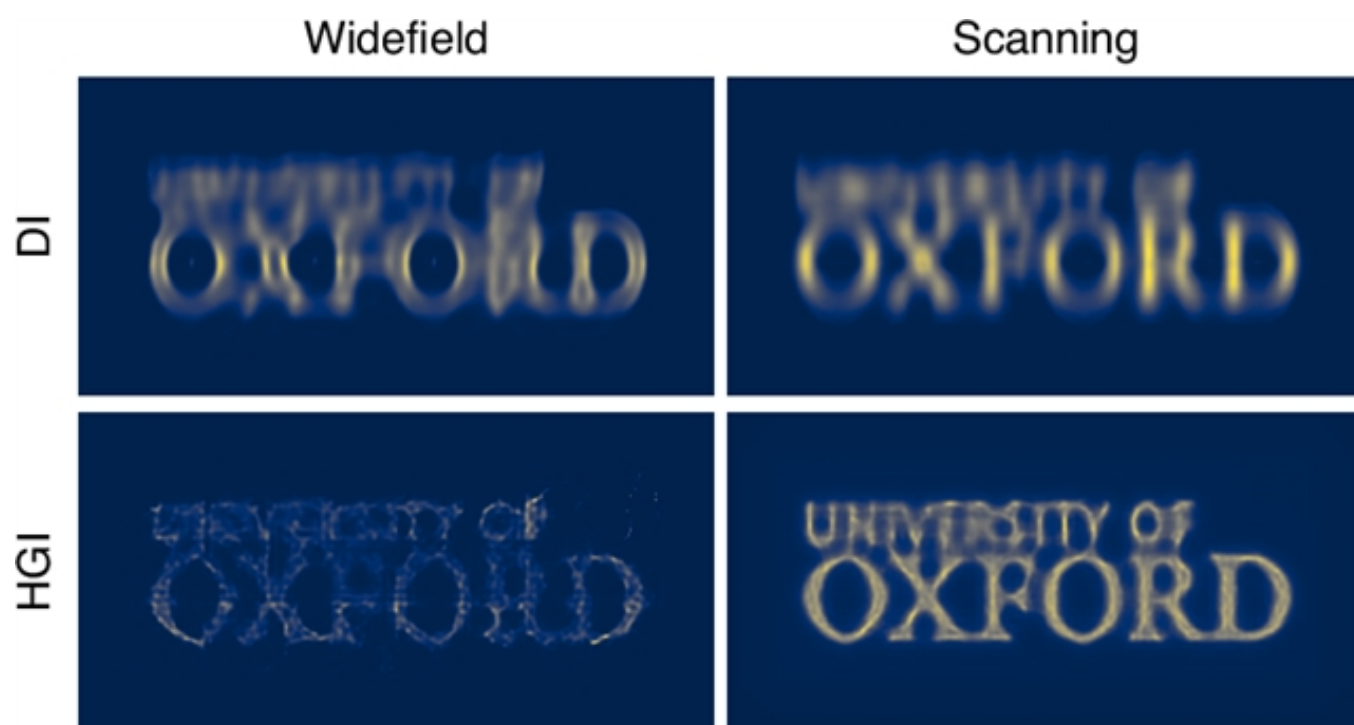
图5. 对在宽场和聚焦扫描照明下通过直接成像（DI）和厄米-高斯成像（HGI）获得的牛津大学校徽图像应用 Richardson-Lucy（R-L）去卷积。
