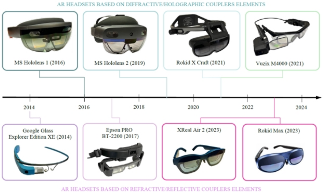
图1：工业AR头显设备技术发展路径：衍射/全息耦合器元件（顶部）和折射/反射耦合器元件（底部）
