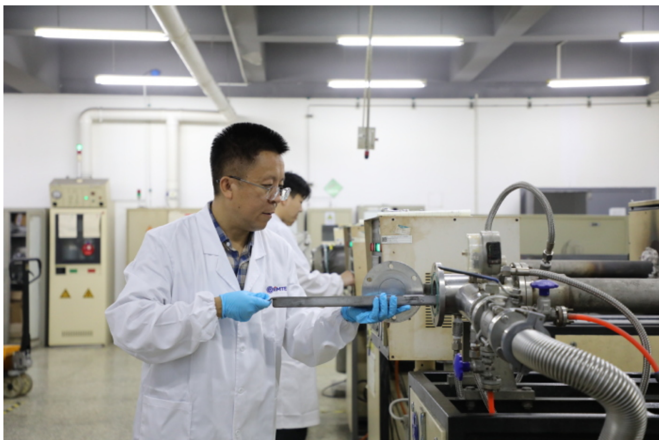
闫阿儒进行稀土永磁材料真空热处理前的装炉准备工作。
