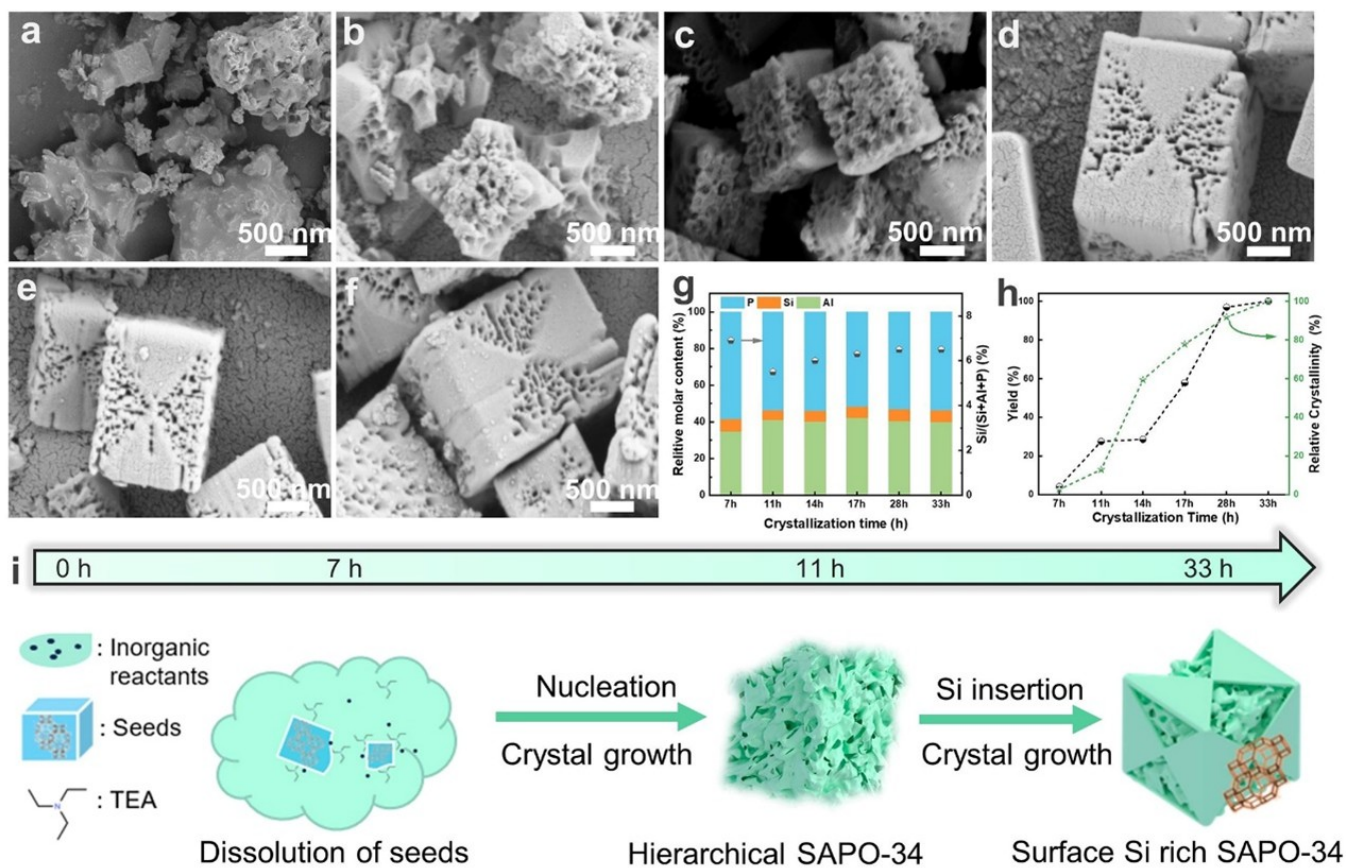
不同晶化时间合成的SAPO-34形貌与等级孔SAPO-34的晶化机理
