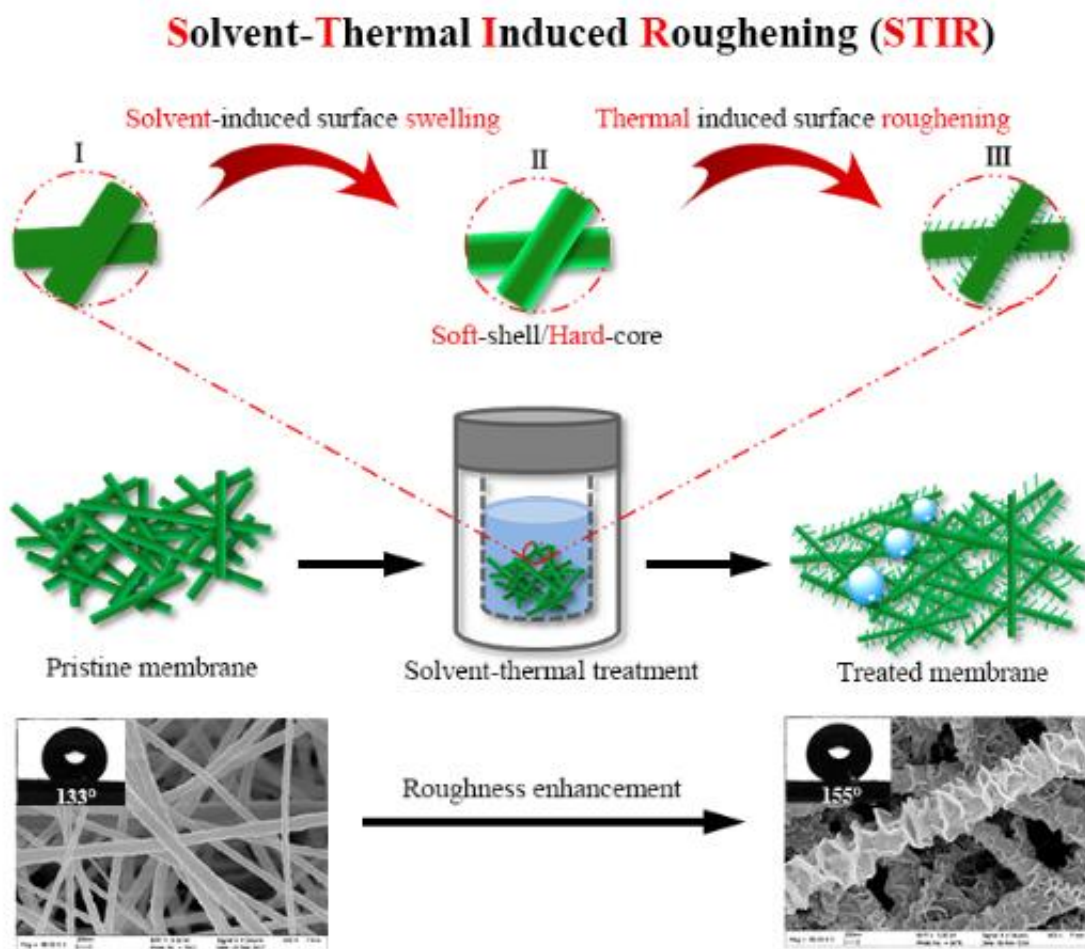
图1. 溶剂/热引发的粗糙过程的原理示意图及粗糙处理前后PVDF纳米纤维膜的形貌结构
