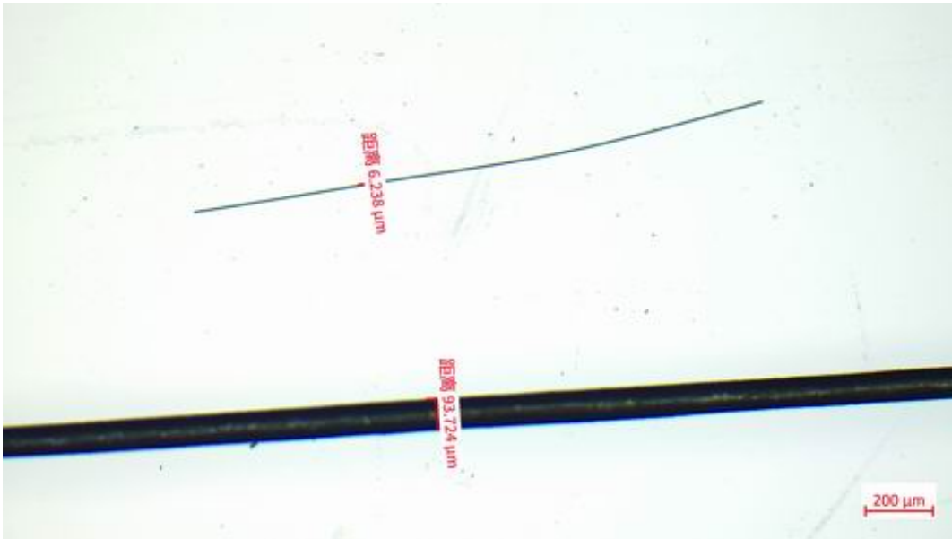
T1000级碳纤维单丝（上）与头发丝的对比。山西煤化所供图
