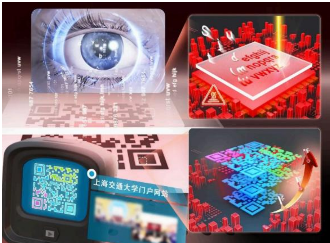
图2可见光-红外无串扰信息读取、可见光信息高温擦除和激光重写，以及二维码红外信息温度渐进显示可手机扫描读取的概念图
