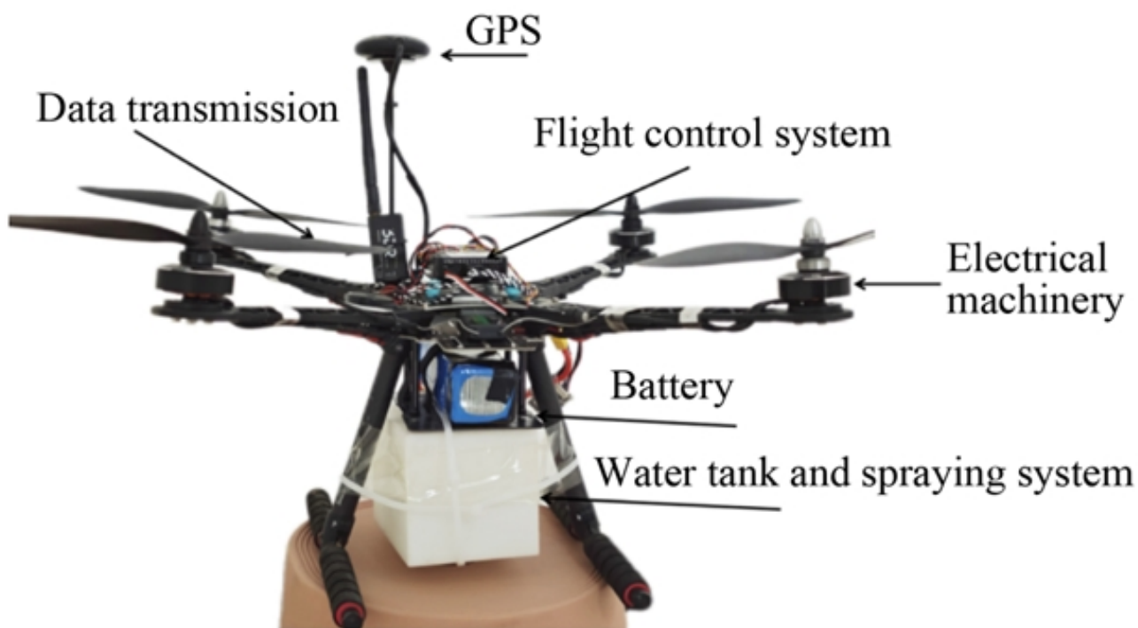
图4 农业植保无人机的组装与配置。
