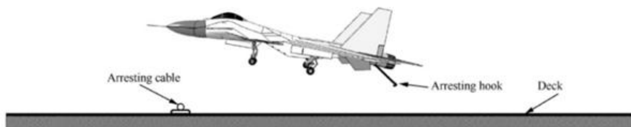
舰载机着舰冲击示意图
